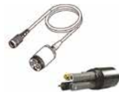
四接口探头: ISE/ISE/ 溶解氧 / 电导率 / 温度
