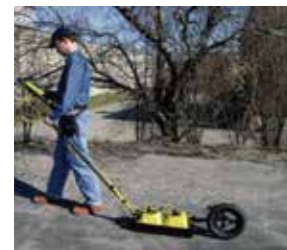
应用四：用地质雷达 (GPR) 探测树木根系分布：
