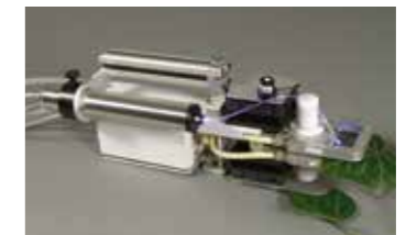
模式二(GFS-3000/F): GFS-3000 连接荧光附件 3050-F,在自然光下或人工光下同步测量气体交换与叶绿素荧光。
