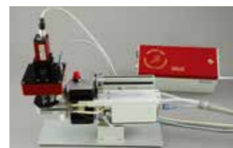
模式一(GFS-3000/IM-MINI): 与 MINI-IMAGING-PAM 联用,在 2 cm x 3.2 cm 的面积上同步测量气体交换与荧光成像。
