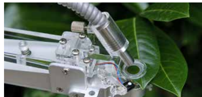
2030-B光适应叶夹，可测量温度、光强
