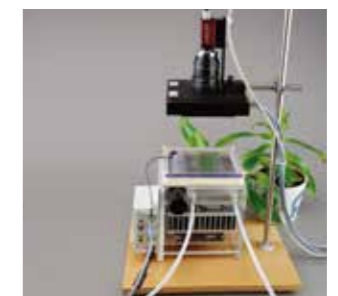
模式三(GFS-3000/IM-MAXI): 与 MAXI-IMAGING-PAM 联用,在 10 cm x 13 cm 的面积上同步测量气体交换与荧光成像。
