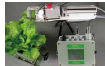
模式三(GFS-3000/M): GFS-3000 与超便携式调制荧光仪 MINI-PAM-II 联用,在自然光下或人工光下同步测量气体交换与叶绿素荧光。MINI-PAM-II 可单独使用。
