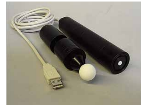
AMOUR的探头和接头 从左至右: 辐亮度、Scalar辐照度、Cosine辐照度和SMA接头
