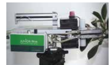
模式四(GFS-3000/J): GFS-3000 与基础型调制荧光仪 JUNIOR-PAM 联用,在自然光下或人工光下同步测量气体交换与叶绿素荧光。JUNIOR-PAM 可单独使用。
