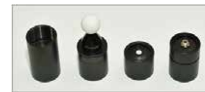
AMOUR的探头和接头 从左至右: 辐亮度、Scalar辐照度、Cosine辐照度和SMA接头
