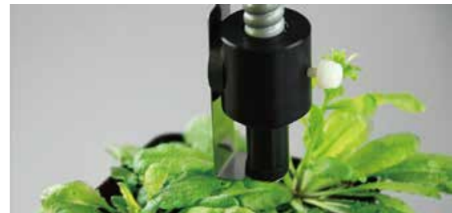
2030-B光适应叶夹，可测量温度、光强
