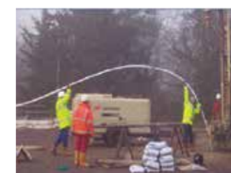
CMT403 系统用于监测地下水氯化溶剂含量变化 (英国 Waterra)
