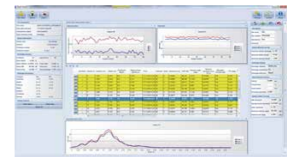
支持中文语言的 FlowTracker 软件,用于波束检验、数据存取、数据可视化和自定义报告
