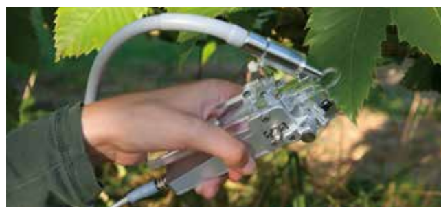
2035-B光适应叶夹，可测量温度、湿度、光强
