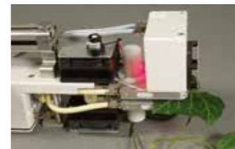
模式一(GFS-3000/FL): GFS-3000 连接荧光附件 3055-FL,在仪器提供的人工光下同步测量气体交换与叶绿素荧光。
