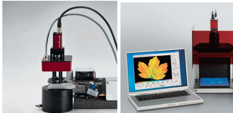
MINI版IMAGING-PAM连接至拟南芥叶室3010-A
